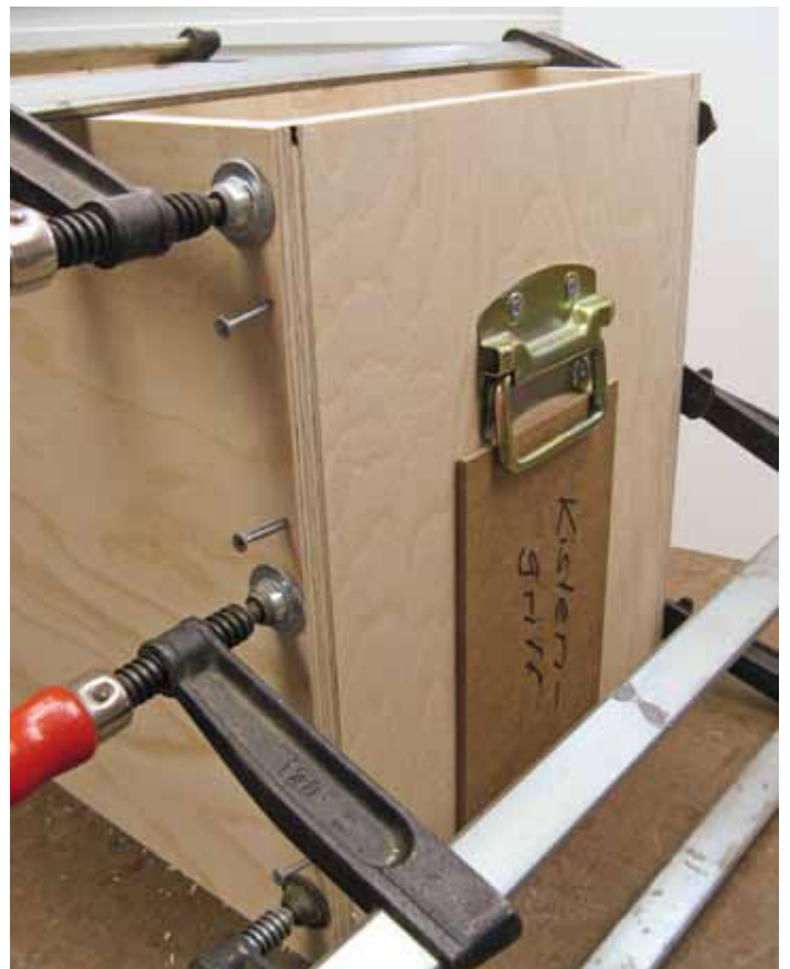
Stirnwände mit Leim bestreichen und mit den Seitenwänden zusammenstecken und mit Schraubzwingen pressen. Zusätzlich mit 8 Holzschrauben 4 x 40 mm sichern.
