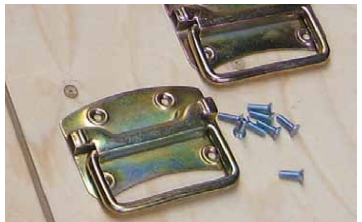
Die Einschlagmutter M5 nach dem Lochbild der Griffe bohren und montieren.
